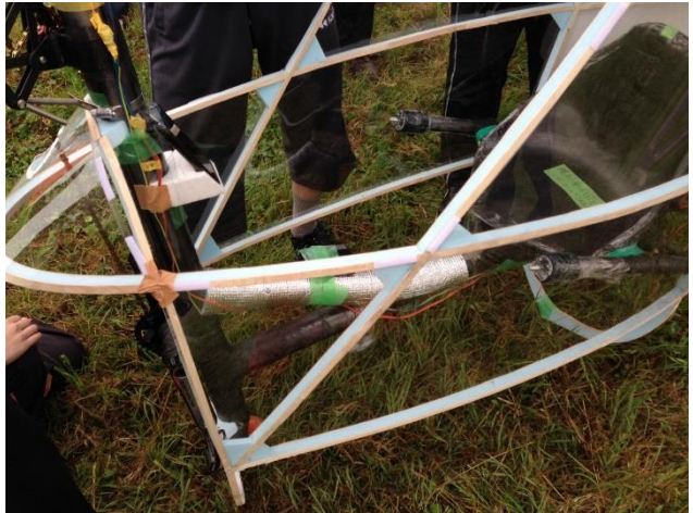
図 1.3 フェアリング骨組みの破損
